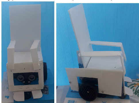
Gambar 2. Prototipe kursi roda sebelum perbaikan (ultrasonik sensor berpotensi terhalang kaki pasien)
